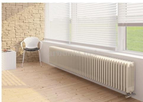
Высота корпуса батареи серии Арбония 5055 составляет 550 мм, боковое подключение радиатора отопления производится с помощью ручной или терморегулирующей арматуры в торцевые отверстия с межосевым расстоянием 480 мм. В состав батареи может входить до 40 секций, диапазон тепловой мощности устройства варьируется от 186 до 5999 м<sup>2</sup>.
