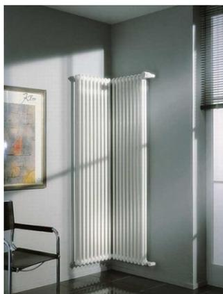
Боковое подключение радиаторов отопления модели Арбония 5050 производится в отверстия диаметром  $\frac{3}{4}$  дюйма, расположенные на верхнем и нижнем торце изделия с межосевым расстоянием 430 мм. Трубчатые радиаторы из стали рекомендуются к эксплуатации в закрытых системах отопления, устанавливаются настенным или напольным способом.
