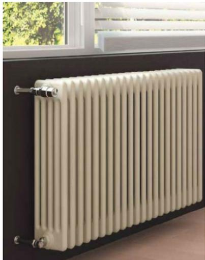
Боковое подключение радиаторов отопления считается универсальным – существует возможность выбора любой основной схемы обвязки. Присоединение трубопроводов производится к торцевым отверстиям диаметром  $\frac{3}{4}$  дюйма, при этом рекомендуется использовать ручную или терморегулирующую арматуру. Она предназначена для управления температурой устройства и отключения в случае необходимости.
