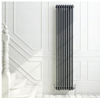
Боковое подключение радиаторов отопления, реализованное на устройствах серии 5120, считается универсальным. Благодаря ему можно выбрать любую из основных схем обвязки радиаторов. Присоединение трубопроводов производится к торцевым отверстиям верхнего и нижнего коллекторов, диаметр отверстий составляет 20 мм. Увеличенное сечение подводов положительно отражается на качестве циркуляции теплоносителя через устройство.
