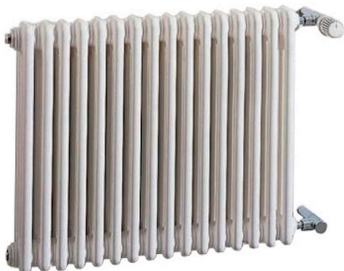
Нижняя подводка к радиатору отопления делает обязательной установку на устройство воздухоотводчика – особенно это актуально для вертикальных версий батарей. Изделия устанавливаются настенным или напольным способом, предназначены для работы в системах водяного отопления закрытого типа.
