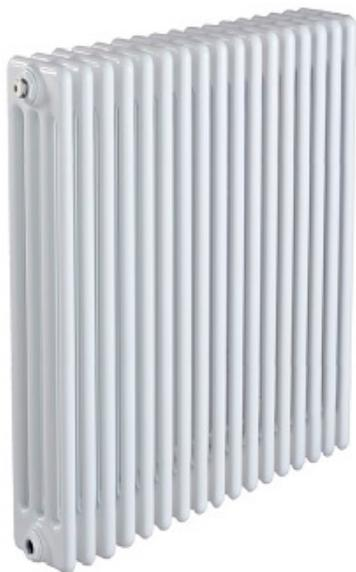
Нижняя подводка к радиатору отопления серии Арбония 2090 оставляет открытыми минимальные участки трубопроводов – это выгодно отражается на общем дизайне помещения. При нижнем присоединении подводок обязательной становится установка воздухоотводчика на отопительный прибор – он необходим для стравливания воздуха.
