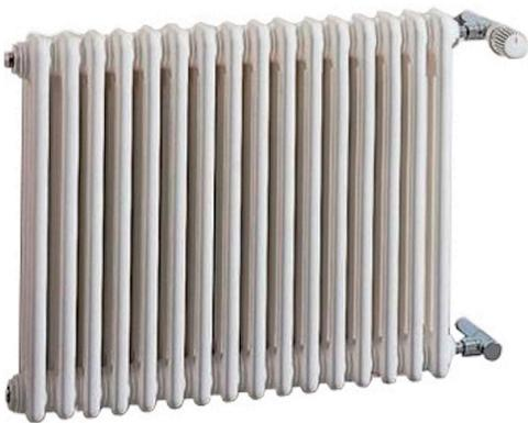
Боковое подключение радиаторов отопления Арбония 3026 позволяет выбрать любую схему обвязки в зависимости от условий монтажа в каждом конкретном случае. Увеличенное сечение подводов  $\frac{3}{4}$  дюйма позволяет пропустить через устройство необходимое количество теплоносителя для качественной работы прибора – это особенно актуально для систем с низкими рабочими параметрами.
