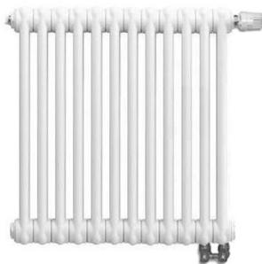
Боковое подключение радиаторов отопления модели Арбония 3055 выполняется в верхние и нижние торцевые отверстия крайних секций, диаметр присоединения – 3/4 дюйма. Такой тип подключения является наиболее распространенным и позволяет выбрать любую из основных схем обвязки отопительных устройств радиаторного типа.
