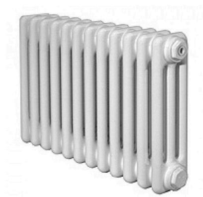
Боковое подключение радиаторов отопления модели Арбония 3060 выполняется в верхние и нижние торцевые отверстия крайних секций, диаметр присоединения –  $\frac{3}{4}$  дюйма. Такой тип подключения является наиболее распространенным и позволяет выбрать любую из основных схем обвязки отопительных устройств радиаторного типа.
